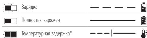
\*В это время красный индикатор продолжит мигать, а когда начнется зарядка, загорится желтый. После того, как батарея достигнет рабочей температуры, желтый индикатор погаснет, и зарядка продолжится. Зарядное(-ые) устройство(-а) не может(-ут) полностью зарядить неисправную аккумуляторную батарею. Зарядное устройство показывает неисправность аккумуляторной батареи, если индикатор не загорается или мигает.
