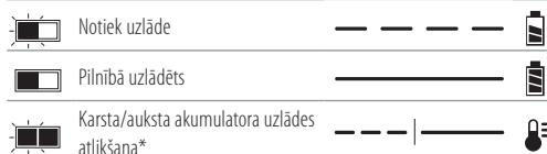
\*Šajā laikā turpina mirgot sarkanā lampiņa un deg dzeltenā lampiņa. Tiklīdz akumulators ir atdzīsis līdz piemērotai temperatūrai, dzeltenā lampiņa izdziest, un lādētājs atsāk uzlādes procesu.
